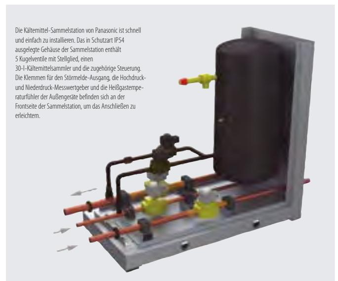
Die Kältemittel-Sammelstation von Panasonic ist schnell und einfach zu installieren. Das in Schutzart IP54 ausgelegte Gehäuse der Sammelstation enthält 5 Kugelventile mit Stellglied, einen 30-l-Kältemittelsammler und die zugehörige Steuerung. Die Klemmen für den Störmelde-Ausgang, die Hochdruck- und Niederdruck-Messwertgeber und die Heißgastemperaturfühler der Außengeräte befinden sich an der Frontseite der Sammelstation, um das Anschließen zu erleichtern.
